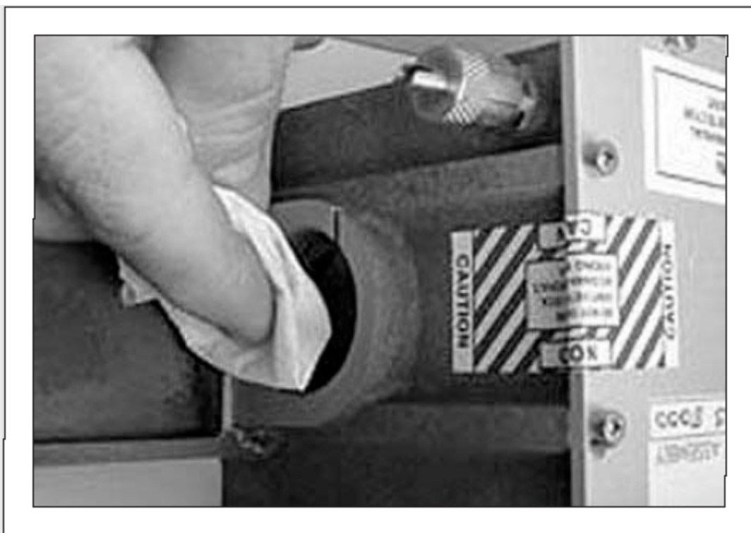
图 7-54 清洗 IR 光具座组件的蓝宝石窗
